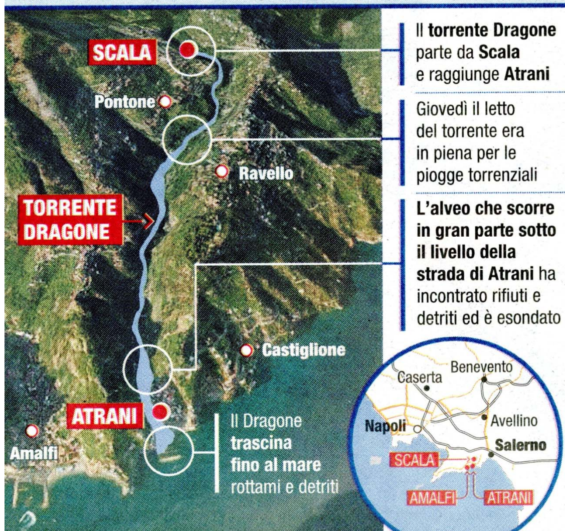
Fig. 6. Il Corriere della Sera dell'11 settembre 2010 ha pubblicato questa cartina che mostra chiaramente dove il tombino entro il quale scorre il torrente è stato ostruito dalla colata detritica che, esondando, ha investito il centro cittadino posto allo sbocco. Nelle figure 7 e 8 altre immagini di Atrani dopo l'evento.
